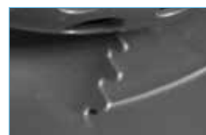
El Serrated Novovent Concept (SCN) incorporado en turbina y directrices
